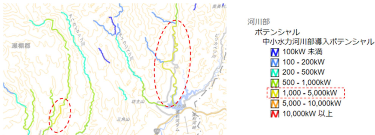
図 4-3 中小水力河川部導入のポテンシャル (出典) 環境省 再生可能エネルギー情報提供システム [REPOS]
