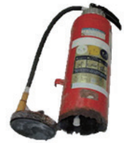
▲破裂して底が抜けた消火器
