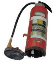
▲破裂して底が抜けた消火器
